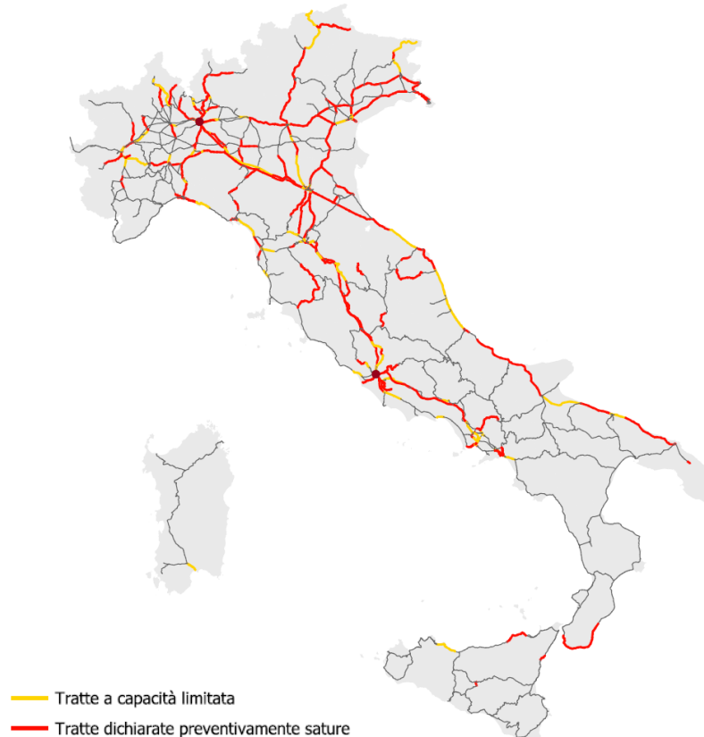
Figura 12 – Grado di utilizzo della rete ferroviaria italiana. Fonte: RFI, Orario di servizio 2023-2024.
